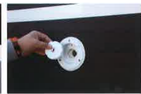
給水タンクに水を補充しやすいよう、リアハッチに水道ホースをそのまま入れられる給水口を備えております。
