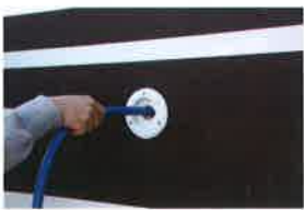
給水タンクに水を補充しやすいよう、リアハッチに水道ホースをそのまま入れられる給水口を備えております。
